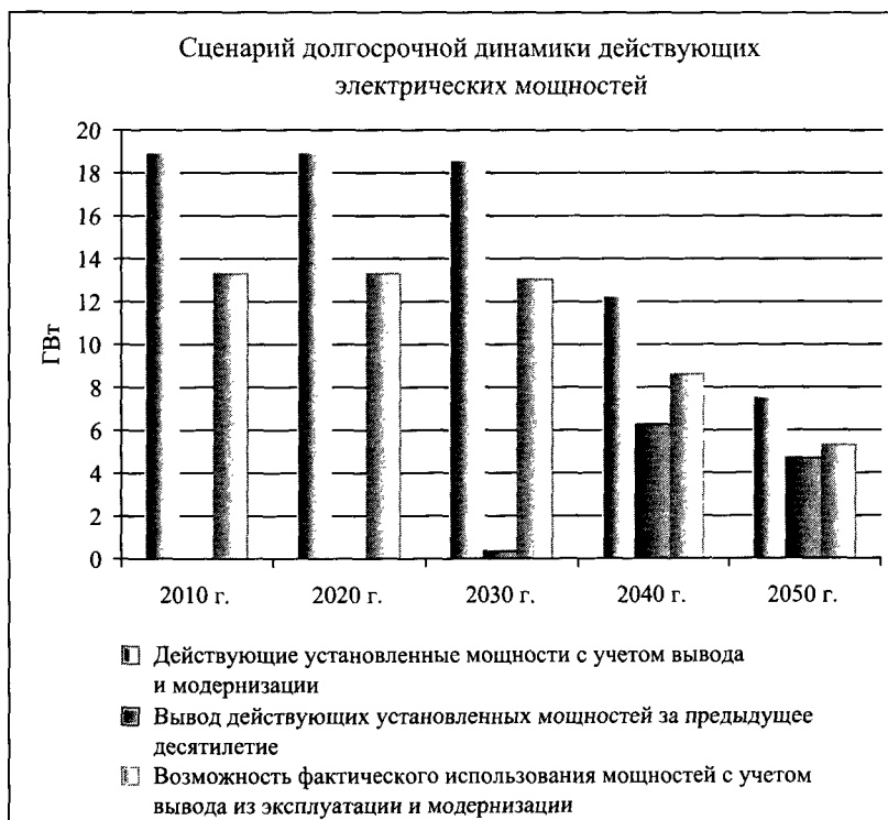
Рисунок 3.4. Примерный сценарий эффективности использования действующих мощностей генерации электроэнергии на период до 2050 года с учетом повышения к.п.д. использования мощности до 70%
