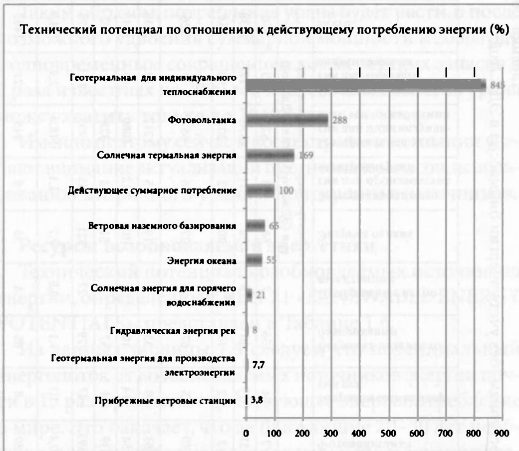
Рисунок 1.4. Сопоставление технического потенциала возобновляемых источников энергии с действующим суммарным потреблением энергии на Земле
